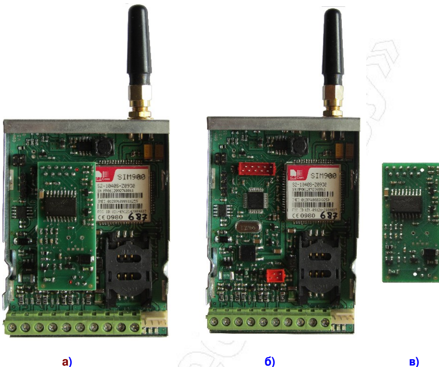
Рис. а) GSM TR2; - в корпусе, без крышки, б) – в корпусе без платы Contact ID; в) - плата Contact ID
