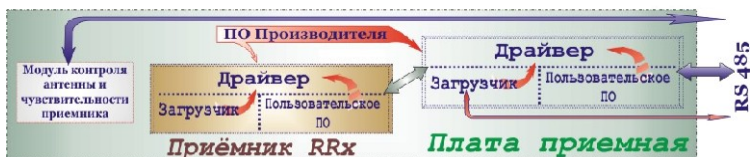
Рис. Структурная схема программного обеспечения платы RX-RRP.
