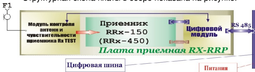
Рис. Структурная схема приёмной платы RX-RRP.
